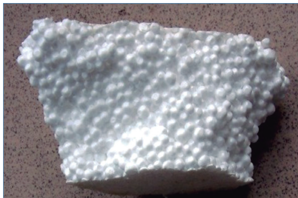
Fragmento de poliestireno expandido. Puede notarse con claridad las cuentas.
